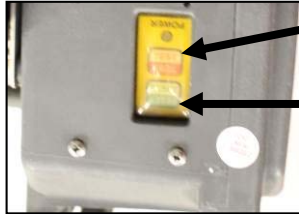
Bouton de réenclenchement du disjoncteur de fuite de terre (GFCI Reset) Bouton test
